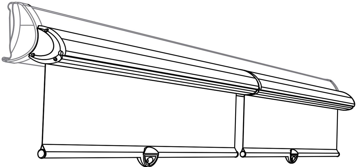
Coffre en aluminium extrudé laqué. Équipé d'un tube d'enroulement en acier et d'une toile ajourée de hauteur maxi 1120 mm.
