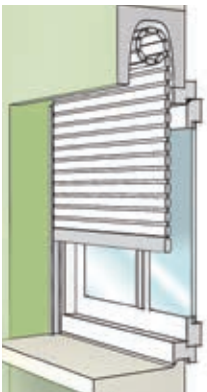
Avec coffre tunnel intégré dans la maçonnerie
