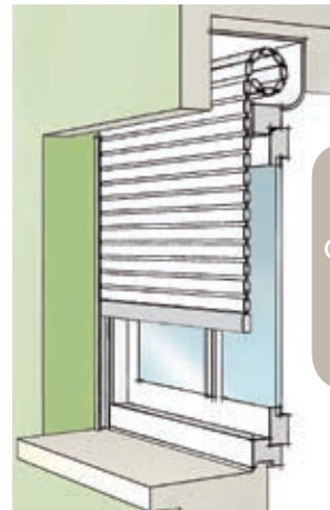
Avec coffre PVC à l'intérieur de la pièce, intégré au bloc fenêtre
