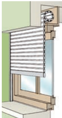
Avec coffre bois existant à l'intérieur de la pièce
