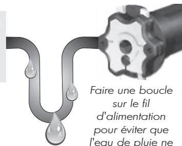
Faire une boucle sur le fil d'alimentation pour éviter que l'eau de pluie ne s'infilte dans la tête moteur.
