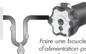
Faire une boucle sur le fil d'alimentation pour éviter que l'eau de pluie ne s'infilte dans la tête moteur.
