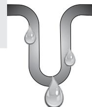
Faire une boucle sur le fil d'alimentation pour éviter que l'eau de pluie ne s'infilte dans la tête moteur.
