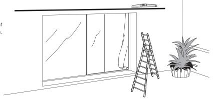
Dans le cas de pose de face sous balcon ou dans le cas de pose plafond, il est nécessaire de prévoir un espace pour le montage du coffre et l'accés aux fixations.
