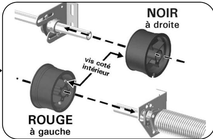
Assemblage du précadre (si porte LB > 3200, la pose de l'arbre se fait à l'étape 14b)
