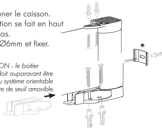
**4** Engager la coulisse **longue** dans le boîtier du haut, puis par rotation l'insérer dans le profil de fermeture.
