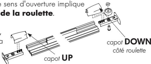
**1** Positionner les boîtiers sur le caisson.
