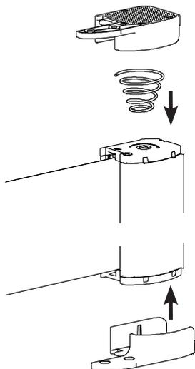
**2** Positionner le profil de fermeture dans l'alignement du dos du boîtier et le fixer. **IMPORTANT** : insérer avant fixation les deux loquets de coulisse.
